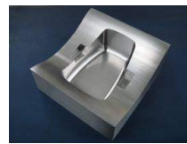
磨き工程を削減する加工パス
