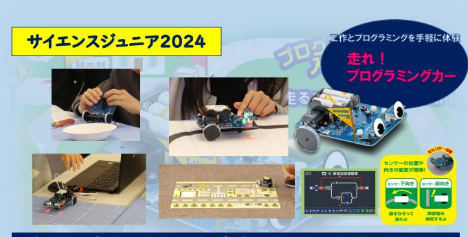
ロボットの工作とプログラミング体験をしました。プログラミングでは、センサーの状態によって動きを制御 したり、ライントレース動作や床検出、前方障害物検出などに挑戦しました。
