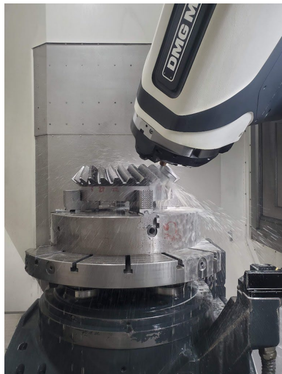
焼き嵌めホルダーを使った仕上げ加工
