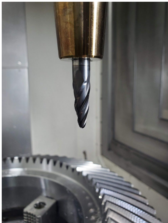
焼き嵌めホルダーを使った仕上げ加工
